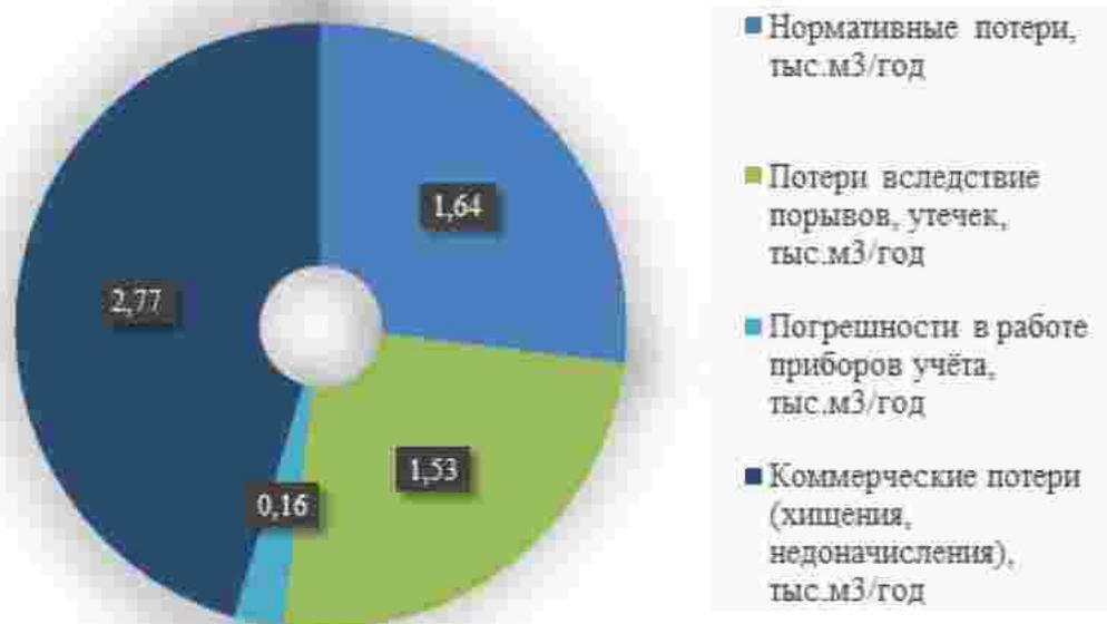
Рисунок 4 – Структурные составляющие потерь питьевой воды при ее производстве и транспортировке
