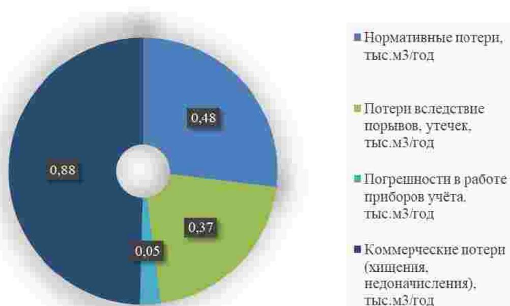
Рисунок 3 – Структурные составляющие потерь питьевой воды при ее производстве и транспортировке
