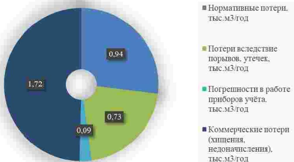
Рисунок 4 – Структурные составляющие потерь питьевой воды при ее производстве и транспортировке
